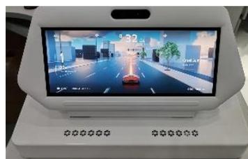
12.3" BD(BOE Dual) Cell 车载显示屏，借助京东方独有的 BD Cell 技术实现高精度控光、超高对比度，清晰还原画面细节和色彩，展现超强的画面表现力，让画面细节纤毫毕现；15.6" Min-LED 显示屏具备百万级别高对比度和超高色域，集成 Mini LED、量子点膜和局域调光技术，色彩还原和显示效果表现出色，还能显著降低功耗；双 12.3 寸木纹表面隐藏显示，显示和装饰一体化，实现从高科技显示到自然美学装饰的自如切换。
