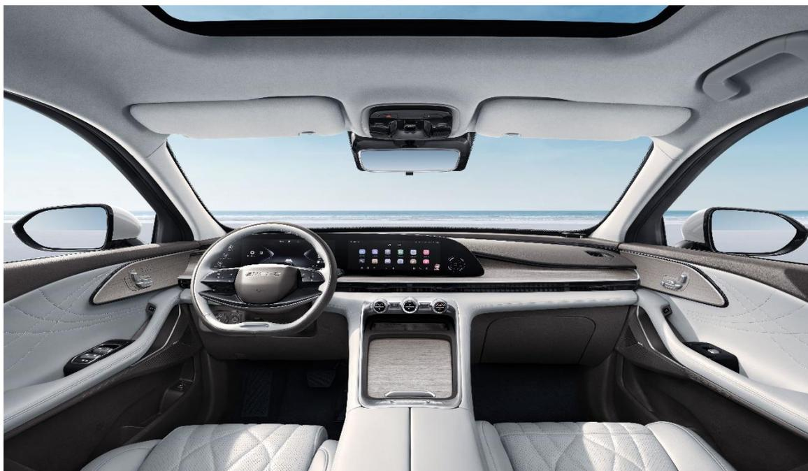
奇瑞星途瑶光 C-DM 搭载京东方精电双 12.3 英寸显示总成，以双联屏曲面设计呈现，采用 LTPS 技术，屏幕轻薄且节能高效，具备高色域、高驱动和高分辨率的优质特性，能够提供绝佳显示效果。在使用场景的便捷性方面，京东方精电双 12.3 英寸显示总成一体化的视觉效果，实现了驾驶信息与多媒体信息的集中、直观展示；在行车过程的安全性保证方面，显示总成不仅做到了大屏、超高清，还通过合理的界面设计和物理按键布局，使驾驶者在行驶过程中也能轻松操作，同时仪表显示区域还支持视频链路异常时的独立显示，全面保证行车安全。
