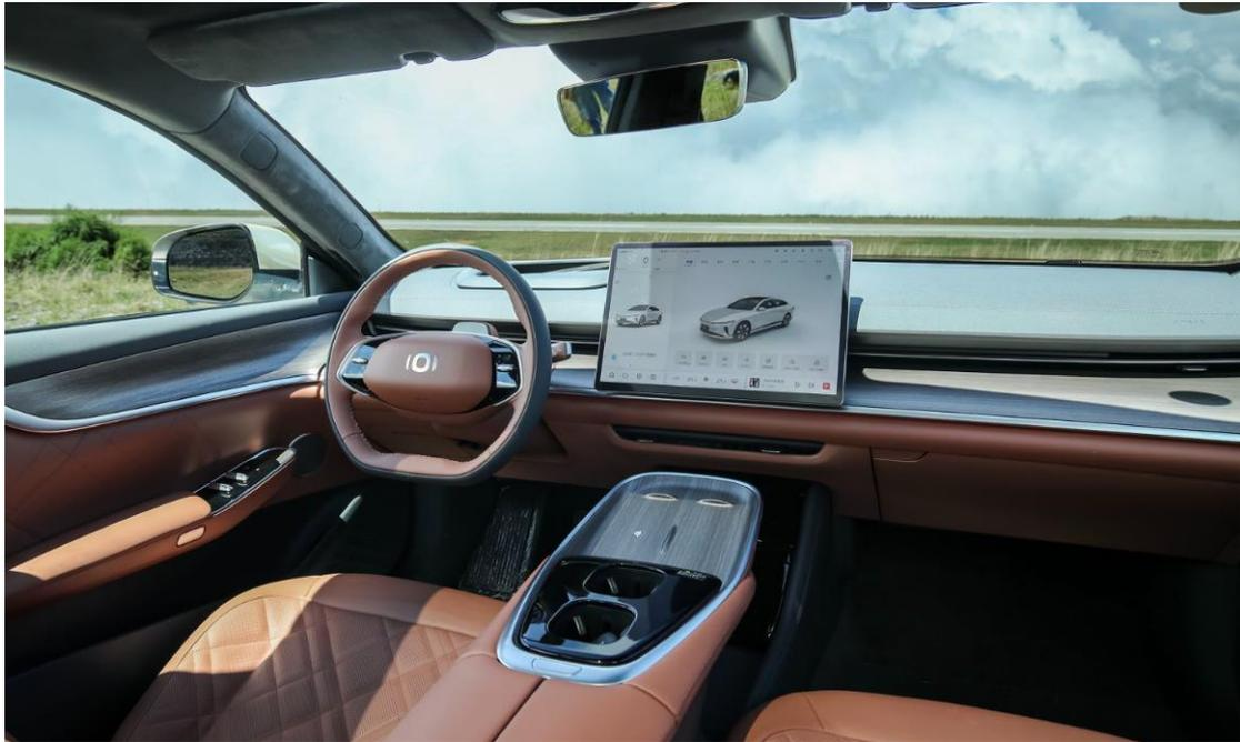
该款启源 A07 内饰舍弃了绝大多数物理按键，也取消了传统的仪表盘，仅在操作台上保留了中控大屏，因此功能绝大多数都集成在京东方这块 2.5K 超高分辨率 15.4 英寸的 LTPS (低温多晶硅) 中控屏上，让屏赋能座舱内的各类场景。京东方与长安是多年
