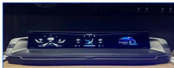
低碳绿色 氧化物（Oxide）低碳工艺技术与Mini LED技术加持，该款车载显示产品可有效降低功耗20%~30%。
