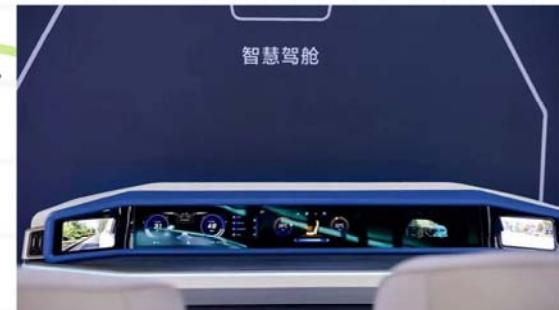
搭载42.2英寸贯穿屏及6.94英寸CMS（电子外后视镜）
