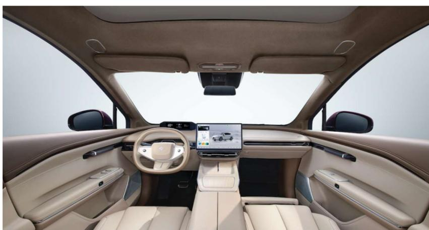
京东方精电在智能座舱仪表和中控显示等方面与广汽集团紧密合作，双方联合创新，不断引领推进车载显示技术革新，树立业内先进标准。广汽旗舰车型 Hyper GT 上搭载由京东方精电提供的国内首款 14.6 英寸氧化物 Incell 车载显示屏，是大尺寸氧化物车载显示屏又一经典案例。这款尖端产品集成 Oxide 氧化物技术特性，具备高分辨率、超窄边框优势，并且能够显著降低功耗，助力低碳节能、绿色出行；以 Incell 一体化触控技术有效减少了屏幕厚度和重量，为 Hyper GT 打造出了更为轻薄时尚、智能化的驾驶舱环境，树立了车载显示领域的新标杆。
