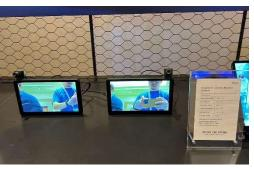
像头对车身四周进行多角度实时拍摄,获取的影像传输到车内 8 寸高清屏幕上,可视角度达到传统后视镜的 3 倍。提供更广视野;通过镜头加热、透雾算法、控光调节等技术实现雨天清晰显示、雾天增强显示和夜晚控光显示,极大提升雨雾风雪天气及夜间行驶的驾乘安全性。不仅如此,该解决方案还可降低整车风阻,提升整车续航能力。
