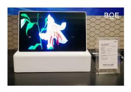
随着 Mini LED 背光技术在车载显示赛道上初露头角,多款搭载 Mini LED 屏幕的汽车陆续发布,其在亮度、对比度、功耗方面有着相较传统背光的技术优势。京东方在此次 SID 上所展示的 **15.6 英寸 Mini LED 全高清车载显示**能够实现百万级对比度,110%高色域,采用高透过率 LTPS 面板,亮度高达 1200nits,以 Mini LED 配合量子点膜技术,还原最真实、饱满的原画色彩,给用户带来极致观感;应用局域调光技术,能够显著降低功耗。
