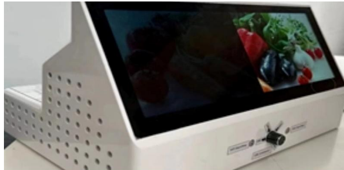
12.3 寸 可切换防窥显示屏，单边可切换防窥显示技术
