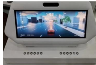
高 PPI 车机裸眼3D，搭载柱状棱镜技术、GUI 交织算法和视觉追踪算法
