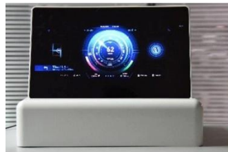
14.6英寸氧化物显示屏，采用氧化物屏技术
