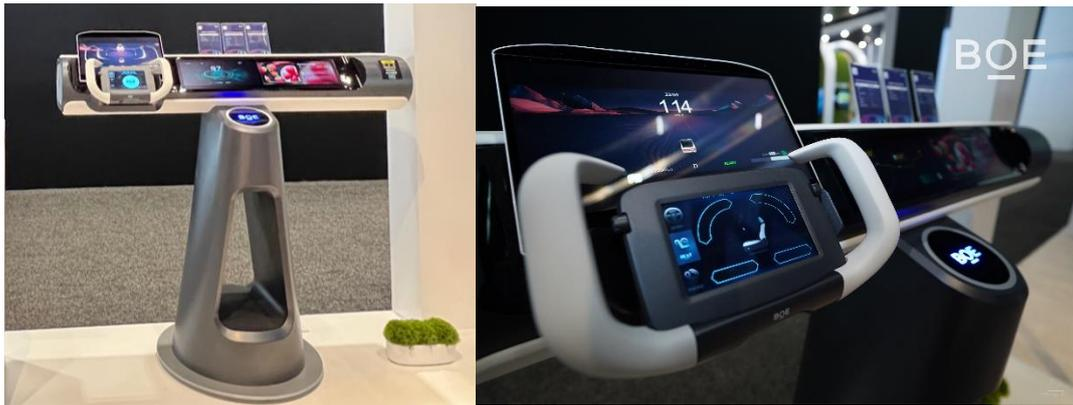
此外，京东方还展出了一款 12.3” 的车规级 3D 显示屏，其亮度峰值可达 1200 尼特，最大视角可达 120°，可应用于仪表、中控、副驾等多类型车载产品。京东方此次还带来了智能防眩（内）后视镜，不同于市场上普遍采用的秒级防眩电致变色方案，京东方采用的是液晶偏转技术方案，通过施加电压调节液晶偏转角度和偏振光原理，实现了毫秒级别的防眩功能以及高透过率，大大提升了行驶过程中的安全性。硬件部分采用 SoD 解决方案，结构设计采用铸铝一体化，使得展品的外观更加精致，也更节省车内使用空间。京东方多年来对车载显示产品在软硬件方面设计不断打磨、优化、升级，将更优质的产品 and 解决方案呈现在消费者的面前。
