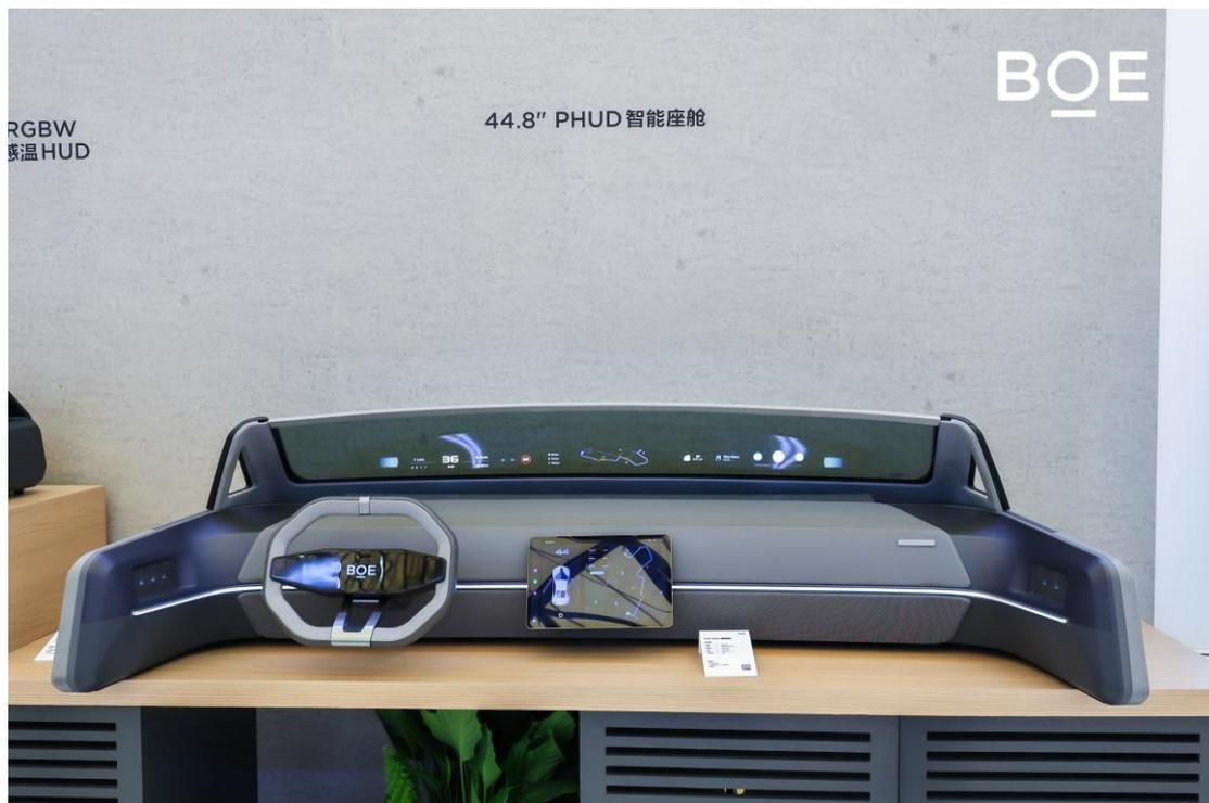
极具科技感的智能方向盘搭载京东方精电全球首发的车载屏下大面积超声波指纹识别技术，识别面积是普通方案的 10 倍以上，同时集成多种智慧化功能：通过指纹识别可辨认不同驾驶员的 ID 信息，可根据不同用户的使用习惯一键切换个性化驾驶模式，自动调整后视镜、方向盘及座椅位置；湿手识别可应用于汽车门把手解锁及车内启动解锁，在雨雪等恶劣天气环境下依然可实现精准的指纹识别解锁。离手监测功能可准确识别出驾驶员是否握持方向盘，对危险驾驶行为及时预警；此外还创新搭载 ECG 心电监测功能，驾驶员双手握持即可监测心电并输出健康监测结果，智能化分析是否疲劳驾驶，未来还将集成血压、血氧等更多监测功能，实现“手握方向盘即完成健康检测”的未来愿景。京东
