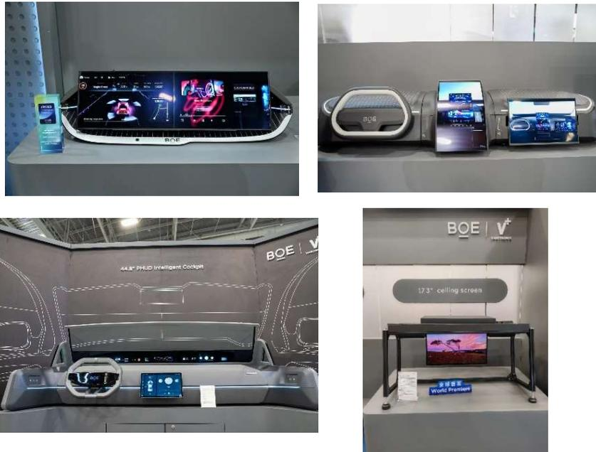
全球首发的高端 UB Cell 智能显示屏, 拥有 3000:1 的超高对比度、0.7% 的超低反射率以及高达 BT2020 95% 的色域; 12.1" 超宽频 (5-144Hz) 的动态刷新平板集成了京东方专有的 set-level 技术, 灵活调整屏幕刷新率。
