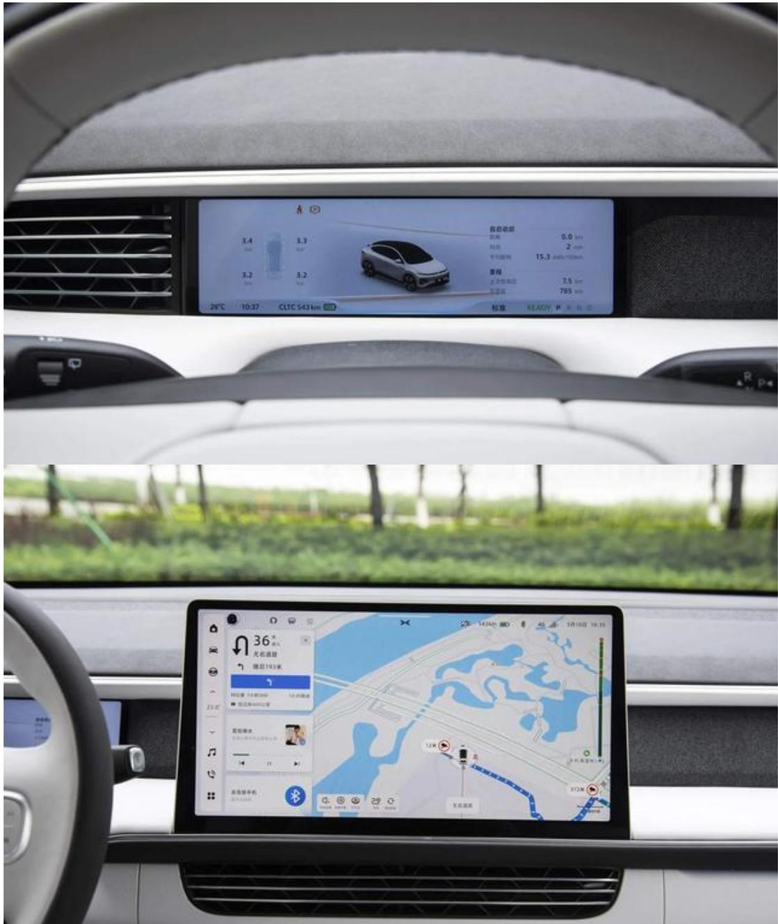
此次发布的小鹏 G6 搭载京东方精电 10.2 英寸高清液晶仪表总成，采用全贴合工艺完美的融入了驾舱内饰，其左右防窥的仪表屏幕有效的降低了车内光线对驾驶员的干扰，一体黑的外观设计带来沉浸式的座舱体验。此外，小鹏 G6 采用京东方精电 14.96 英寸悬浮式中控总成，高分辨率及对比度使得画质能够完美呈现在一体式的中控屏幕上，其优于行业的屏幕反射率能够适应任何条件下的行驶环境。
